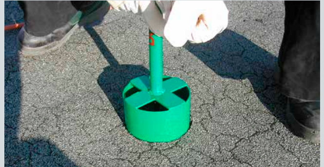
Abb. 17/1: Mit Spezialwerkzeug wird ein Schichtenpaket komplett ausgeschnitten.
