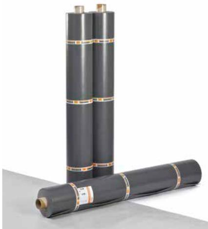
BauderTHERMOFOL U sind universelle Kunststoffdachbahnen, die in Dicken von 1,5 bis 2,4 mm hergestellt und mit einem Synthesegebebe verstärkt werden. Zusätzlich sind die Dachbahnen durchwurzelungsfest nach FLL-Richtlinien und gegen Mikroorganismen ausgestattet.
