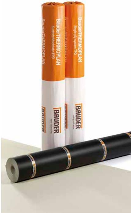
BauderTHERMOPLAN T 15/18/20 sind Kunststoffdachbahnen, die in Dicken von 1,5 bis 2,0 mm hergestellt und mit einem Synthesegebebe verstärkt werden. Dies verleiht ihnen Dimensionsstabilität, eine hohe Reißfestigkeit sowie eine den Anwendungen exakt angepasste Reißdehnung.
