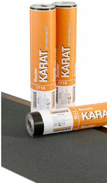
Polymerbitumen-Schweißbahn mit einer mechanisch extrem hochbelastbaren Polyesterverbundträgereinlage in Verbindung mit einer höchstwertigen Bitumenrezeptur. Beschieferung in den Farben grünweiß sowie in dem Design-Ton granitschwarz. Granitschwarz ist ein Naturton, der nicht entfärbt, aber eine gewünschte Farbtonschwankung beinhaltet.
