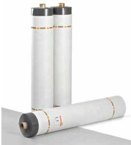
BauderTHERMOFOL U 15 V ist eine 1,5 mm dicke PVC-P - Kunststoffdachbahn, die mit einem Synthesegebebe armiert und zusätzlich unterseitig mit einem Spezialvlies kaschiert wird. Dies verleiht ihr neben den bewährten Eigenschaften der gewebeverstärkten Bahnen die Möglichkeit zur windsogssicheren Verklebung mittels zugelassener PU-Kleber.
