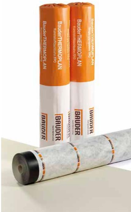
BauderTHERMOPLAN T 15/18/20 V sind Kunststoffdachbahnen, die in Dicken von 1,5 bis 2,0 mm hergestellt werden. Sie sind mit einem Synthesegebebe verstärkt und zusätzlich unterseitig mit einem Spezialvlies kaschiert. Dies verleiht ihnen neben den bewährten Eigenschaften der gewebeverstärkten Bahnen die Möglichkeit zur windsogsicheren Verklebung mittels zugelassener PU-Kleber.
