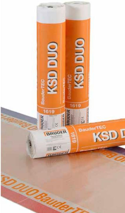
Kaltselbstklebende Elastomerbitumen-Dampfsperrbahn mit variabler Nahtverklebung. Bei der Verlegung dieser Dampfsperre entsteht keinerlei thermische Belastung der Unterkonstruktion. Geringe Höhenversätze im Naht- und Stoßbereich verbessern die Lagestabilität von biegesteifen Dämmstoffen.
