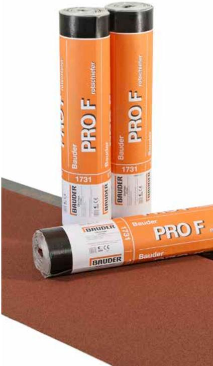
BauderPRO F ist eine höchstwertige, beschieferte Elastomerbitumen-Abdichtungsbahn für die einlagige Verlegung gemäß DIN 18531 bei mindestens 2% Dachneigung.
