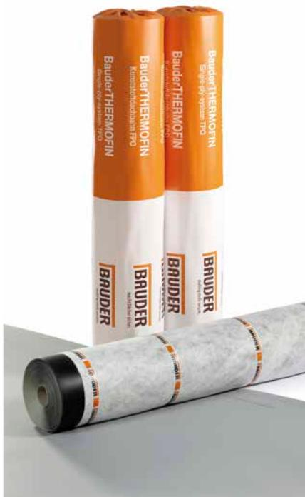
BauderTHERMOFIN F 15 V ist eine 1,5 mm dicke Kunststoffdachbahn, die mit einem Glasvlies armiert und zusätzlich unterseitig mit einem Spezialvlies kaschiert wird. Dies verleiht der Dachbahn neben den Eigenschaften der Standardbahn die Möglichkeit zur windsog-sicheren Verklebung mittels zugelassener PU-Kleber.
