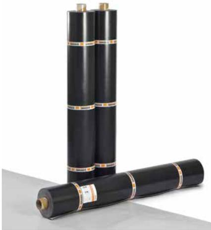
BauderTHERMOFOL M sind Kunststoffdachbahnen für die lose Verlegung, mechanisch befestigt, die in den Dicken 1,5 bis 2,0 mm hergestellt und mit einem Synthesegebebe verstärkt sind. Dies verleiht ihnen die Dimensionsstabilität, eine hohe Festigkeit sowie eine den Anwendungen exakt angepasste Dehnung.
